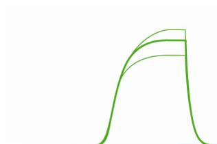
Параметр  $P_{\text{Инсп}}$  определяет давление на вдохе. Это максимальное давление, которое достигается при вдохе.
